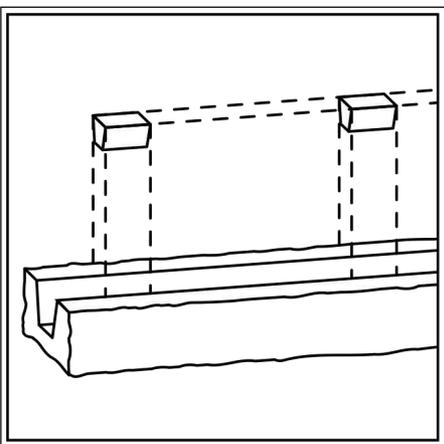
**4.** Расположите заготовки клиньев через каждый метр на потолочной поверхности.
