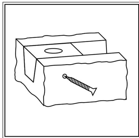
**3.** Затем нанесите клей из тубы на балку (лучше использовать специальный клей для полиуретана) и закрепите ее с помощью винтов к заготовке.
